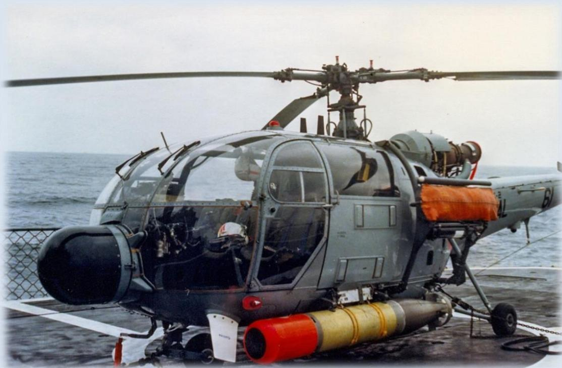
**Helicóptero Naval 61 armado con torpedo MK 44.**
